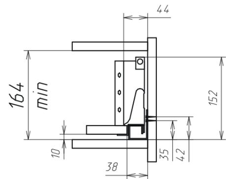
Размер для крепления задней стенки
