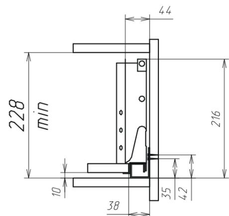
Размер для крепления задней стенки
