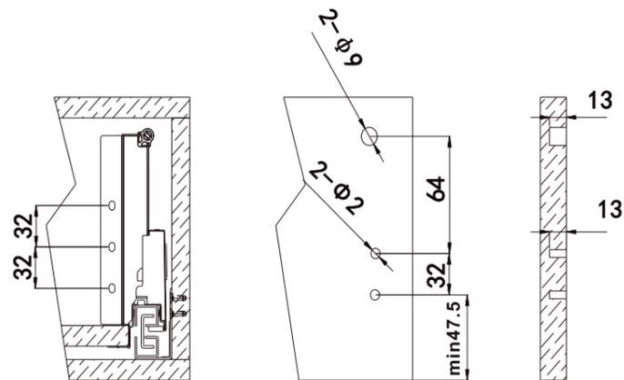
Размер для крепления фиксаторов на внутренней поверхности фасада
