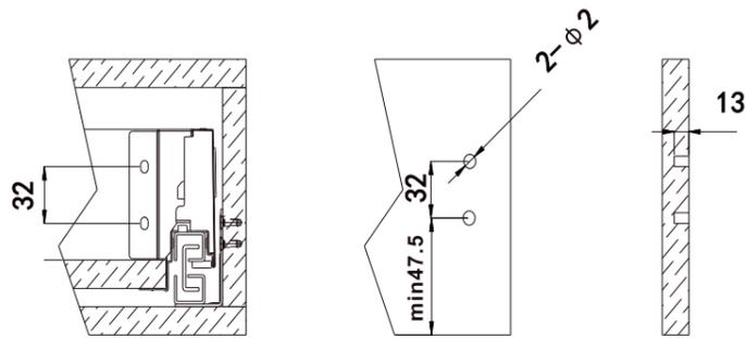
Размер для крепления фиксаторов на внутренней поверхности фасада
