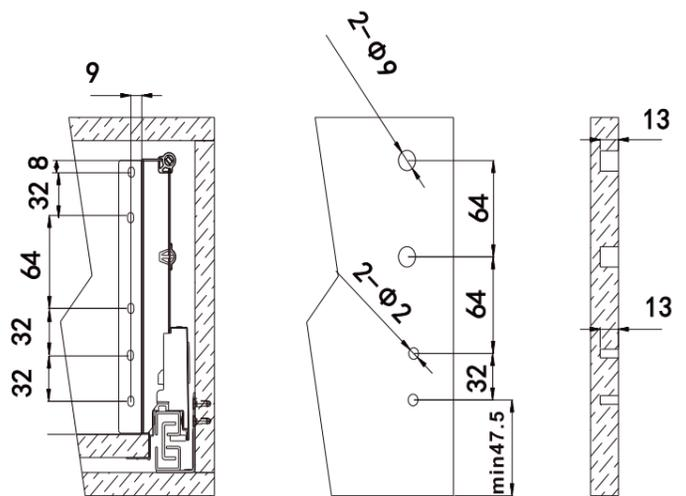
Размер для крепления фиксаторов на внутренней поверхности фасада
