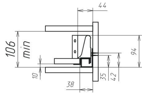
Размер для крепления задней стенки
