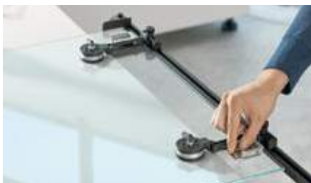
Простое определение позиций благодаря шаблону для наклеивания
